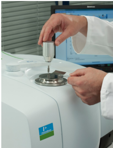
配有ATR附件的Frontier红外光谱仪
